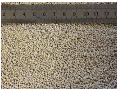
MgO+ Bentonite Pellets
